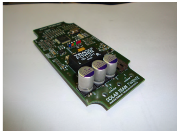
Een node van de CAN-bus
