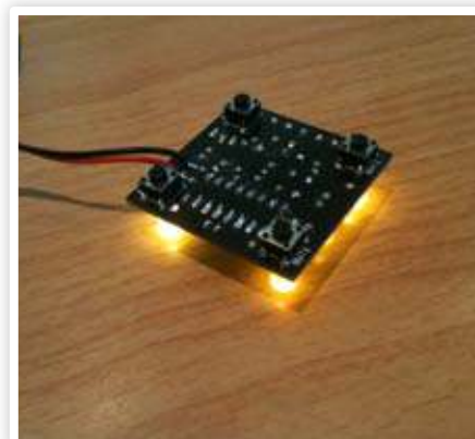
De drukknopjes bevinden zich op de onderzijde van de print.
