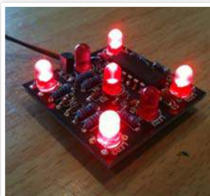
De vernieuwde, vierkante printplaat met grotere LED's.
