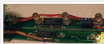
Figuur 1: Het IC solderen.
